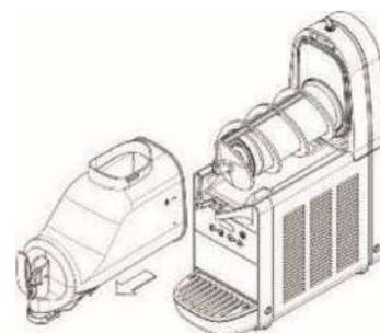
Cuve en polycarbonate antichoc, facilement démontable
