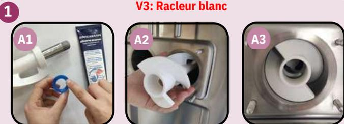
Lubrifier et installer le joint arrière sur les racleurs. Insérer les racleurs en tournant jusqu'au fond (**on doit ressentir l'effet ressort**)
