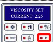
Réglage de la densité (viscosité)
